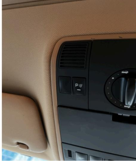
Pのマークがコーナーセンサー解除ボタンです。センサーが過敏に反応するので、気になる場合はこちらのボタンを押して解除してください。
