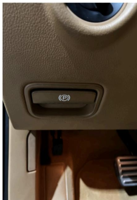
サイドブレーキをかけるのはフットですが解除はレバーで行います。こちらの車の特性上、レバーを引いてもサイドブレーキが解除しきれないので、レバー解除時にフットレバーを足で軽く引いてください。そうすることで完全にサイドブレーキが解除できます。
