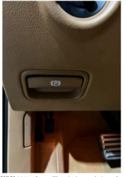
サイドブレーキをかけるのはフットですが解除はレバーで行います。こちらの車の特性上、レバーを引いてもサイドブレーキが解除しきれないので、レバー解除時にフットレバーを足で軽く引いてください。そうすることで完全にサイドブレーキが解除できます。
