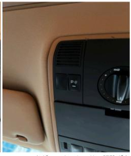
Pのマークがコーナーセンサー解除ボタンです。 センサーが過敏に反応するので、気になる場合は こちらのボタンを押して解除してください。
