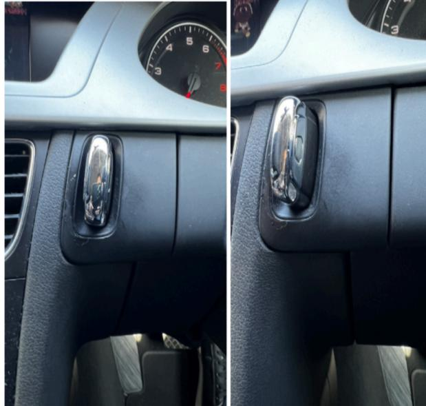
ハンドル左側にキーを差し込んで押すとエンジン始動ができます。エンジン切る際も再度押すと抜けます。
